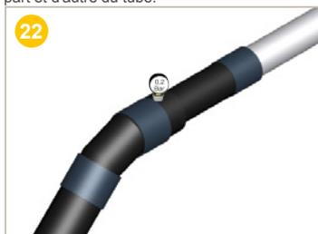
**Recommandations** : Il est recommandé d'effectuer un test d'étanchéité à l'air à 0,2 bar avec une pompe manuelle et un manomètre. Si cela n'est pas possible, effectuer un contrôle visuel. Il est impératif de laisser refroidir à température ambiante avant de réaliser l'injection de la mousse polyuréthane.
