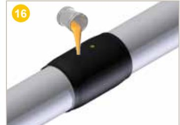
**Verser** le mélange dans l'un des trous d'injection de la manchette PEHD de diamètre 26 mm. Veiller à vider complètement le mélange en utilisant la spatule fournie à cet effet.
