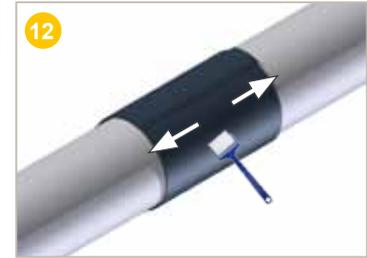
Quand la surface de la bande est encore chaude et malléable, utiliser le rouleau d'application pour **lisser** et **évacuer** les bulles d'air.
