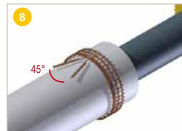
⚠ **Les extrémités des grilles de soudage ne doivent pas se toucher et être écartées d'environ 6 à 8mm.**
