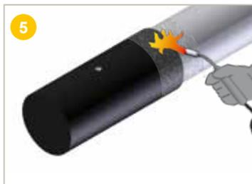
A l'aide d'un flambard, **préchauffer** la surface à recouvrir jusqu'à un minimum de 65°C.
