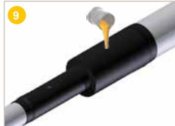
**Verser** le mélange dans le trou d'injection de la manchette PEHD de diamètre 25 mm, et correspondant au plus gros diamètre de tube. Veiller à vider complètement le mélange en utilisant la spatule fournie à cet effet.
