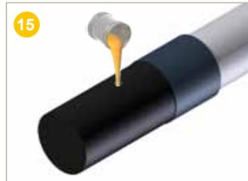
**Verser** le mélange dans le trou d'injection de la manchette de fin de ligne de diamètre 26 mm. Veiller à vider complètement le mélange en utilisant la spatule fournie à cet effet.
