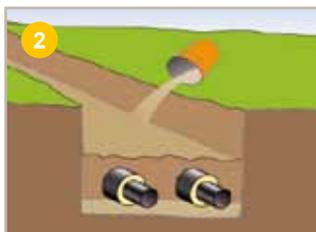
**Damer** le sable manuellement sur les côtés et entre les tubes, en évitant tout choc sur les gaines PEHD. Etaler une couche de sable uniforme affleurant au niveau du sommet des tubes
