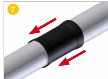
Faire coulisser la manchette non percée sur la partie à isoler de façon à recouvrir la gaine PEHD de 5 à 10 cm de chaque extrémité.
