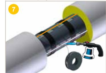
1) Solder le connecteur à l'aide d'une lampe à souder et de fil d'étain. Procéder à un test de traction manuel des conducteurs connectés.
