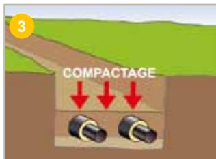
**Etaler** une couche uniforme de sable de **10 cm minimum d'épaisseur** au dessus des canalisations et la damer soigneusement.
