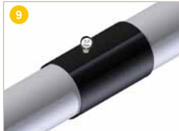
1) **Percer** un 1<sup>er</sup> trou de 25 mm de diamètre dans la manchette à l'aide d'une perceuse en veillant à **ne pas percer sur la soudure de la coupe longitudinale**.
