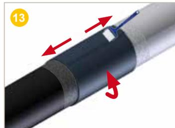
**Appuyer** fermement sur les deux extrémités de la bande thermorétractable.
