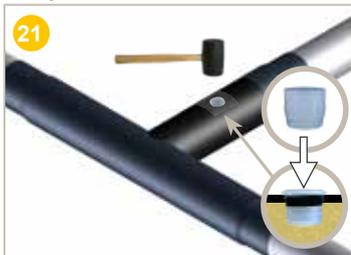
1) **Enfoncer** manuellement le bouchon de fermeture de **type femelle** dans les trous d'injection de la manchette PEHD jusqu'à arriver en butée maximum.
