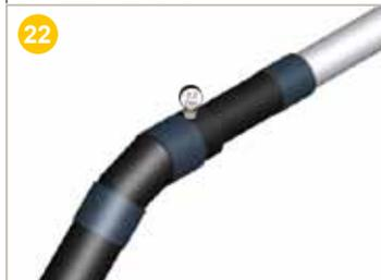
**▲ Rappel :** Effectuer un test d'étanchéité à l'air à 0.2 bar avec une pompe et un manomètre. Si cela n'est pas possible, effectuer un contrôle visuel. Il est impératif de laisser refroidir à température ambiante avant de réaliser l'injection de la mousse polyuréthane.
