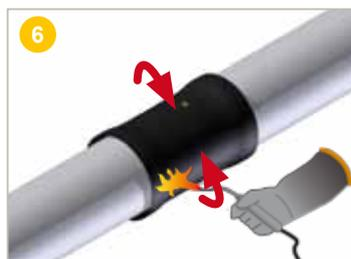
**Rétreindre** les extrémités de la manchette thermorétractable à l'aide d'un flambard. Utiliser un seul flambard pour les Ø ≤ ou égal à 450 mm et 2 flambards pour les Ø > 450 mm. Si 2 torches sont utilisées, se positionner de part et d'autre du tube.
