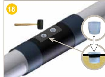
1) **Enfoncer** manuellement les 2 bouchons de fermeture de **type femelle** dans les trous d'injection de la manchette PEHD jusqu'à arriver en butée maximum.
