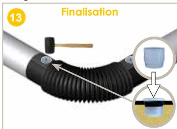
1) **Enfoncer** manuellement les 2 bouchons de fermeture de **type femelle** dans les trous d'injection de la manchette PE flexible jusqu'à arriver en butée maximum.
