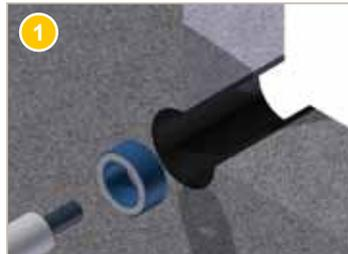
1) Percer un trou de réservation dans le mur d'un diamètre supérieur de 20 à 30 mm au diamètre extérieur du tube.
