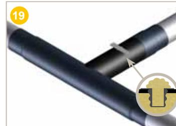
1) **Enfoncer** le bouchon d'évent dans le trou d'injection jusqu'à arriver en butée maximum.
