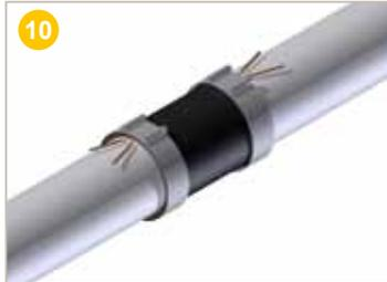
⚠ Laisser refroidir la manchette avant l'opération d'électro-soudure. Après le rétreint et le retour à une température ambiante, **mettre en place** les colliers de serrage sur la manchette thermorétractable.
