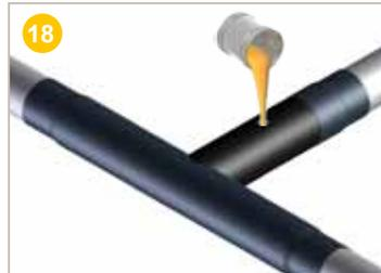
**Verser** le mélange dans le trou d'injection de la manchette PEHD (b) de diamètre 26mm . Veiller à vider complètement le mélange en utilisant la spatule fournie à cet effet.
