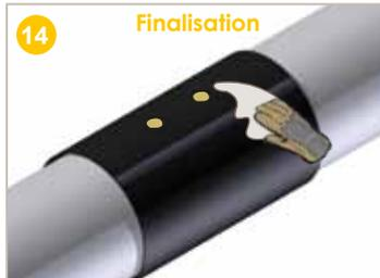
14) **Nettoyer** la surface pour enlever toute particule de polyéthylène ou de sable en utilisant un chiffon sec (ou le souffle d'une flamme).
