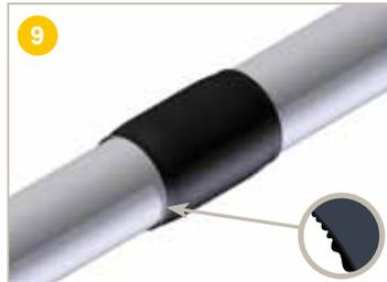
⚠ **N'oubliez pas de retirer le film de protection et de vérifier la présence des bandes de mastic avant de rétreindre la manchette thermorétractable.**
