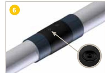
Le système est correctement installé lorsque 2 cordons de soudures homogènes (bourlets) sont visibles sur toute la circonférence des bouchons de fermeture.
