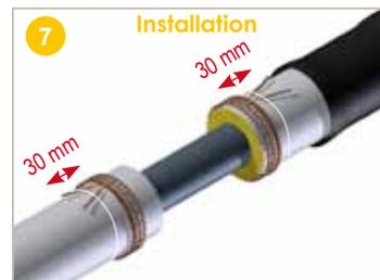
Mettre en place les grilles de soudage à environ 30mm des marques effectuées. Maintenir les grilles en place à l'aide de 3 agrafes (140/8) à chaque extrémité des grilles puis utiliser un marteau pour s'assurer de leur enfoncement.
