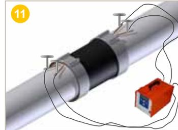
Connecter les câbles de la machine à souder aux pattes des grilles de soudage. Si les 2 bandes sont soudées en même temps, connecter le câble de liaison intermédiaire. Sélectionner la dimension de la gaine à souder puis débiter la soudure en appuyant sur la touche OK. La soudure s'arrête automatiquement une fois réalisée.
