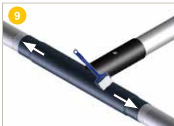
Quand la surface de la bande est encore chaude et malléable, utiliser un rouleau d'application pour **lisser** la bande et évacuer les bulles d'air.
