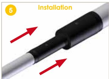
Faire **coulisser** la manchette réduite PEHD au niveau de la zone dénudée de telle sorte qu'elle recouvre la gaine du tube de **10 cm de chaque extrémité**. ⚠ **N'oubliez pas de retirer le film de protection avant de rétreindre la manchette thermorétractable.**
