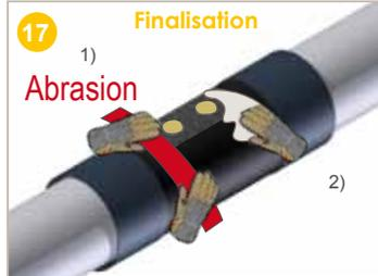
1) **Abraser** les surfaces à recouvrir ( $\varnothing$  trou + 50 mm de chaque côté) avec du papier de verre ou à l'aide d'une brosse métallique.
