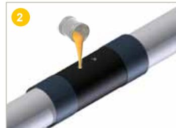
**Verser** le mélange dans l'un des trous d'injection de la manchette PEHD de diamètre 25 mm.
