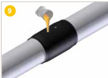
**Verser** le mélange dans l'un des trous d'injection de la manchette PEHD de diamètre 26 mm.
