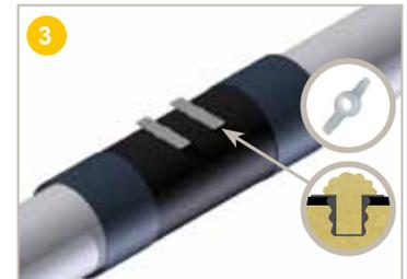
1) **Enfoncer** les 2 bouchons d'évents dans les 2 trous d'injection jusqu'à arriver en butée maximum.
