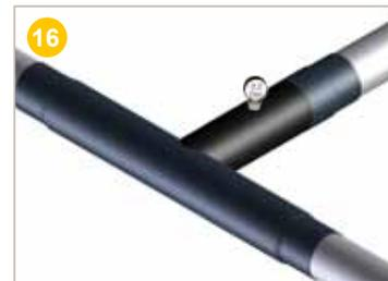
⚠ **Effectuer un test d'étanchéité** à l'air à 0.2 bar avec une pompe et un manomètre. Si cela n'est pas possible, effectuer un **contrôle visuel**. Il est impératif de laisser refroidir à température ambiante avant de réaliser l'injection de la mousse polyuréthane.
