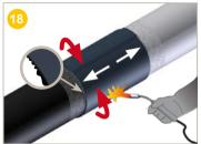
Continuer à **chauffer** en partant du centre vers chaque extrémité jusqu'au rétreint complet. Terminer par des mouvements horizontaux sur toute la surface du manchon.
