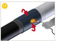
Rétreindre la bande thermorétractable sur sa circonférence par de larges mouvements en commençant par le centre. Selon le diamètre, utiliser un seul flambard pour un diamètre < ou égal à 450 mm et deux flambards pour un diamètre >450 mm. Si 2 torches sont utilisées, se positionner de part et d'autre du tube.
