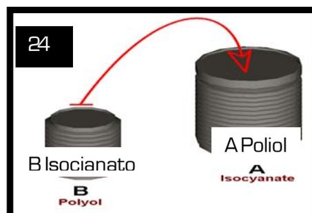
Extraer de las cajas de los kits los componentes A y B. Cuidado comprobar la fecha de caducidad del kit. Verter el componente B en el componente A, mezclar el conjunto mediante la espátula. La mezcla está lista cuando es homogénea y sin huellas de color.
