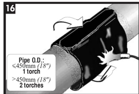
En función del diámetro del PE, utilizar un único soplete para un diám. < o igual a 450 mm y dos sopletes para un diám. >450 mm. Retraer el manguito con movimientos anchos, empezando por el centro de la circunferencia del tubo. Si se utilizan dos sopletes, los aplicadores deberían encontrarse el uno y el otro a ambos lados del conducto.
