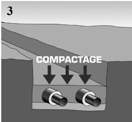
Apisonar la arena manualmente por los lados y entre los tubos, evitando cualquier choque en las fundas PEHD. Extender una capa de arena uniforme que sobrepase el nivel superior de los tubos
