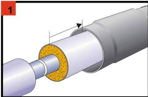
Durante la soldadura procurar alejar lo suficiente el manguito. No retirar la protección de plástico (blanca) del manguito demasiado pronto. Ésta impide una retracción accidental del manguito.
