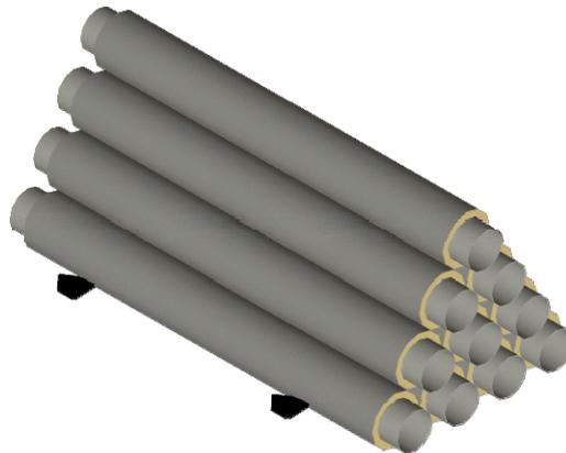
Las piezas estarán dispuestas por categoría y por diámetro. Colocar las tes y los codos orientando los brazos hacia abajo para así evitar la penetración de agua en caso de almacenaje a la intemperie.
