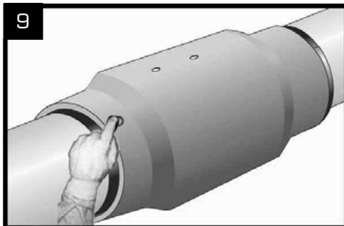
Tras la retracción y la vuelta a la temperatura ambiente, comprobar la adherencia correcta manguito/funda.
