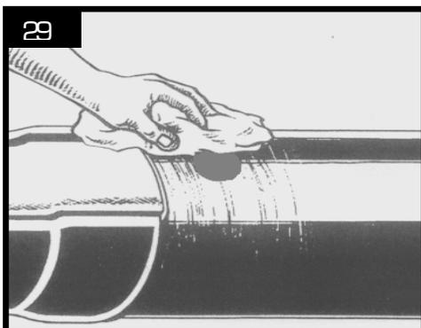
Limpiar la superficie ahora rugosa para quitar cualquier partícula de polietileno o de arena utilizando un trapo seco (o el soplo de la llama).
