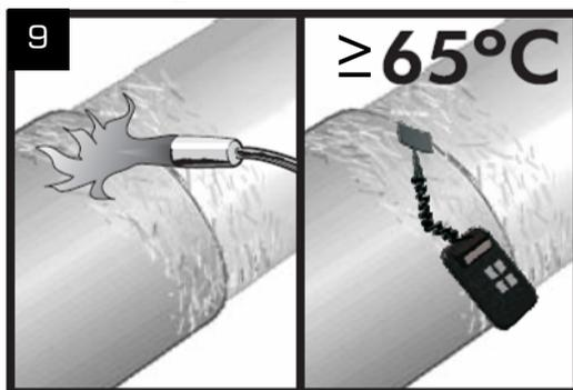
Mediante el soplete, pre-calentar la superficie a cubrir (anchura del manguito + 50 mm a cada lado) hasta un mínimo de 65°C. Controlar la temperatura en toda la superficie mediante un termómetro.
