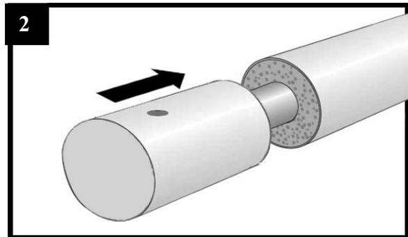
Limpiar con cuidado los extremos de los tubos o de las piezas para eliminar cualquier huella de agua, de barro o de arena. Rascar la espuma de la cara divisoria (Cualquier huella de espuma húmeda debe ser eliminada de los extremos). A continuación deslizar el manguito de final de tramo sobre la funda PE.
