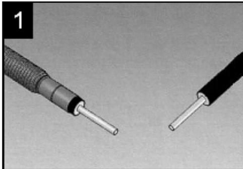
Colocar el manguito PE flexible termoretráctil con el film en las fundas antes de realizar la soldadura.
