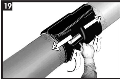
Cuando el manguito aún está caliente y blando, utilizar un rodillo de aplicación para alisar y evacuar las burbujas de aire.
