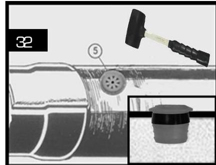
Insertar la cuña hasta que la extremidad de la cuña esté a ras del tapón hembra. Comprobar la colocación correcta del montaje.
