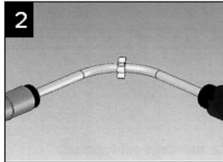
Durante la soldadura procurar alejar lo suficiente el manguito. No retirar la protección de plástico (blanca) del manguito demasiado pronto. Ésta impide una retracción accidental del manguito.
