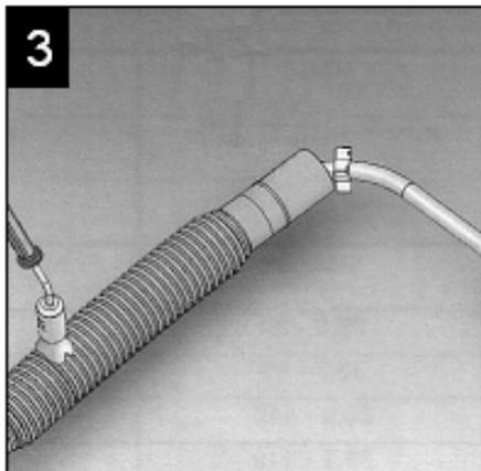
Calentar ligeramente la parte flexible del manguito y pasar con precaución el codo flexible en el codo de acero. Los agujeros de inyección deben estar orientados hacia arriba.
