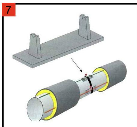
Colocar los cables sobre los separadores. Procurar que los cables de detección no puedan estar en contacto con el tubo caloportador.
