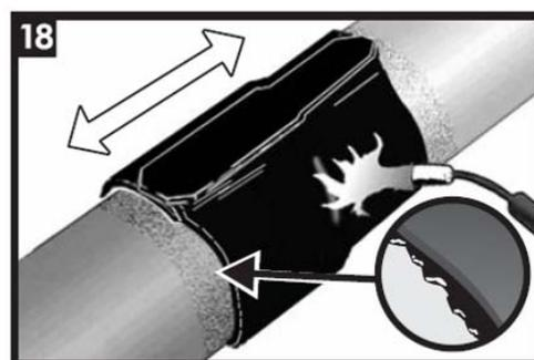
La retracción se ha completado cuando el adhesivo sobresale por los lados del manguito.
