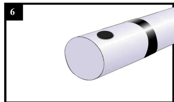
Instalar los tapones de cierre y colocar la pastilla termoretráctil. (Ver imágenes 33 a 36 puesta en obra del Kit Inyectado Manguito i1).
