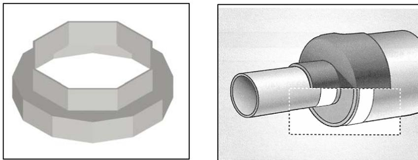
El pasa muros es una junta de estanqueidad entre la funda PEHD y una estructura de hormigón. El uso de un pasa muros es imperativo en cada cruce de la obra por la red (cámara de válvulas, penetración de edificio, etc...). Permite que la canalización pre-aislada se dilate sin daños en el paso del muro.
