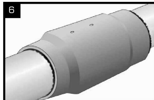
Para los diámetros 630 y 730 Colocar las bandas de masilla sobre la funda PEAD del tubo con la ayuda de una marca. (recubrimiento de 50 a 100 mm).
