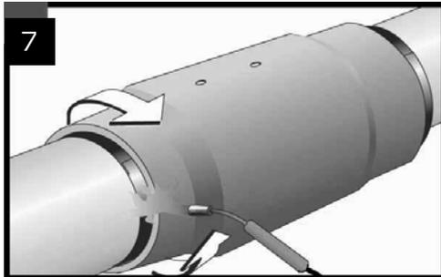
Colocar el manguito sobre la parte que se debe aislar y retraer los dos extremos mediante la llama. En función del diámetro del PE, utilizar un único soplete para un diám. < o igual a 450 mm y dos sopletes para un diám. >450 mm. Si se utilizan dos sopletes, los aplicadores deberían encontrarse el uno y el otro a ambos lados del conducto.
