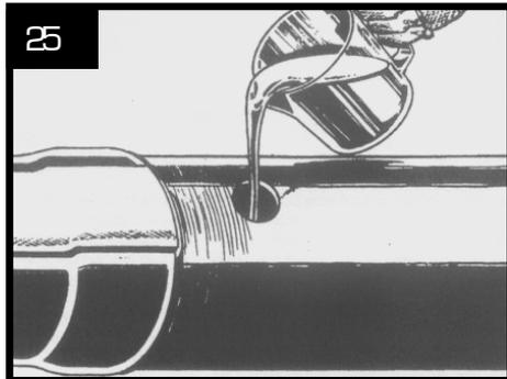
Verter la mezcla por uno de los orificios de 26 mm de diámetro del manguito PEHD. Procurar vaciar completamente la caja utilizando la espátula entregada para ello.
