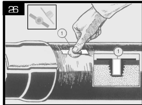
Introducir los dos tapones de aireación en los dos orificios hasta llegar al tope máximo.
