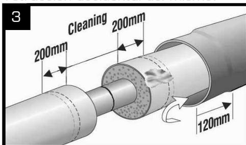
Limpiar la superficie ahora rugosa para quitar cualquier partícula de polietileno o de arena utilizando un trapo seco (o el soplo de la llama).
