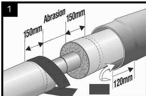
Hacer que el extremo del PEHD sea rugoso sobre una anchura del 150 mm a cada lado, utilizando papel de lija (grano 40-60) o en su defecto mediante un cepillo metálico. No retirar la protección de plástico blanco del manguito. Ésta impide una retracción accidental del mismo.
