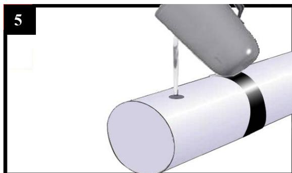
Tras el enfriamiento, se recomienda realizar una prueba con aire del Kit de final de tramo (0,3 bar). Inyectar espuma e instalar el tapón de venteo. (Ver imágenes 23 a 32 puesta en obra del Kit Inyectado Manguito i1).
