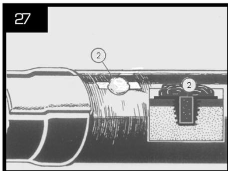
Cuando la mezcla se ha expandido en el tapón endurecido, retirar entonces los tapones con la mano mediante dos manetas previstas para ello. Limpiar el excedente de espuma PU que haya desbordado.
