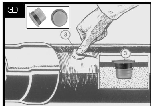
Introducir a mano los dos tapones de cierre de tipo hembra en los orificios del manguito PEHD hasta llegar al tope máximo. Comprobar que la junta de estanqueidad esté correctamente colocada.
