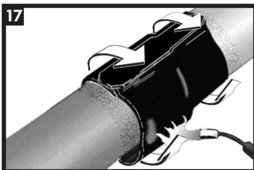
Seguir calentando empezando por el centro hacia una extremidad hasta la retracción completa. Retraer la otra extremidad del mismo modo. Acabar con movimientos horizontales en toda la superficie del manguito.
