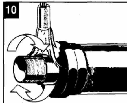
Retraer el forro en el tramo y en el tubo caloportador, manteniendo la llama en movimiento alrededor del tubo. Dejar de calentar cuando la retracción esté realizada y que la superficie esté totalmente lisa.
