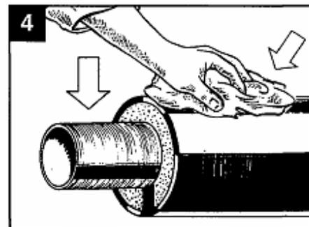
Quitar cualquier partícula de abrasión del tubo y de la funda mediante un trapo limpio y seco.
