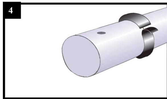
Retraer la banda termoretráctil en el extremo del manguito PE. (ver imágenes 3 a 22 puesta en obra del Kit Inyectado Manguito i1).
