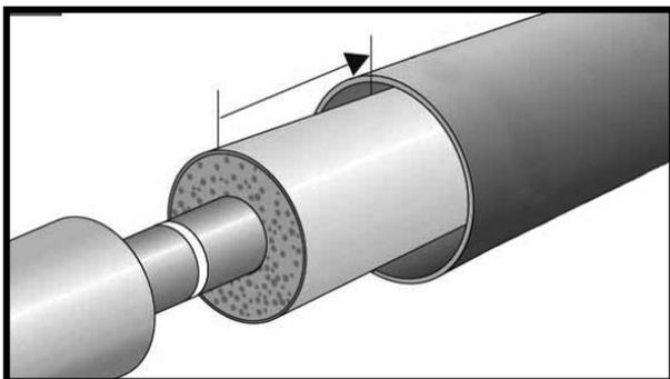
Durante la soldadura procurar alejar lo suficiente el manguito. Tras la soldadura y la prueba hidráulica, las uniones se pueden aislar. Lo ideal es una ejecución con climatología seca.
