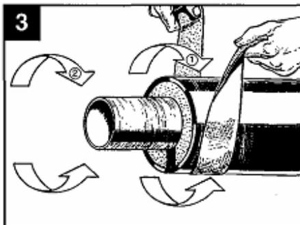
Lijar la funda mediante una tela esmeril. Y lijar el tubo caloportador.
