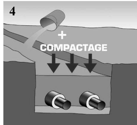
Extender una capa uniforme de arena de 10 cm de espesor encima de las canalizaciones y apisonarla con cuidado.
