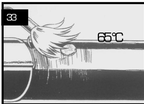
Mediante el soplete, pre-calentar la superficie a cubrir (diámetro del agujero + 50 mm a cada lado) hasta un mínimo de 65°C. Controlar la temperatura en toda la superficie mediante un termómetro.
