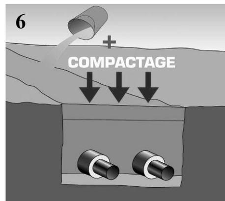
Realizar el relleno por capas sucesivas de 0.30 m con tierra depurada de elementos superiores a 100 mm y compactadas una tras otra.
