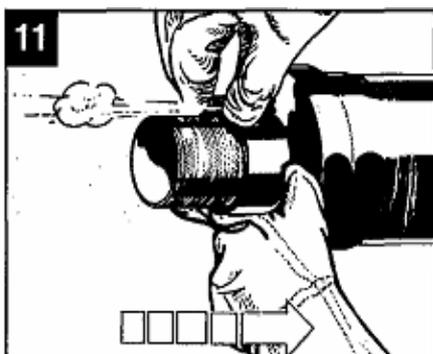
Si es necesario, hacer presión con el forro sobre el tubo caloportador para evacuar las burbujas de aire. Se puede comprobar la adherencia correcta empujando el forro en una pequeña distancia a lo largo del tubo caloportador. La pequeña arruga que se ha formado debe volver a estar plana inmediatamente.
