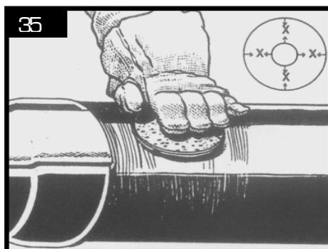
Acabar el pegado calentando hasta que los puntos de color situados encima desaparezcan. Cuando la pastilla termoretráctil aún está caliente y blanda, utilizar un rodillo de aplicación para alisar y evacuar las burbujas de aire.
