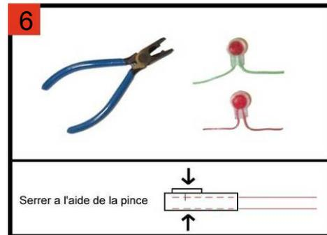
Introducir los cables en el conector y llevar sus extremidades a tope. Quidado acoplar el cable rojo con el cable rojo y el cable verde con el cable verde. Longitud del conductor en el interior del conector: 10mm r el conector mediante la pinza. El conector está bloqueado cuando la tapa está totalmente introducida en el cuerpo. Proceder a un test de tracción manual de los conductores conectados.
