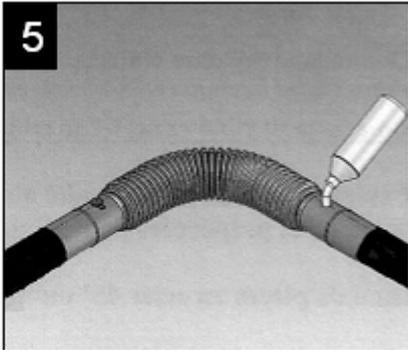
Tras el enfriamiento, se recomienda realizar una prueba con aire del codo flexible (0,2 bar).
