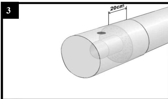
Deslizar unos 20 cm el manguito de final de tramo sobre la funda PE.
