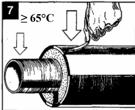
Controlar la temperatura de la funda y del tubo caloportador mediante un termómetro.
