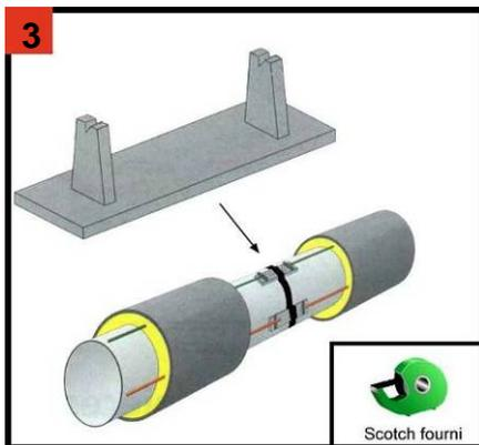
Colocar los separadores sobre el tubo caloportador. Para fijarlos, utilizar el adhesivo entregado.
