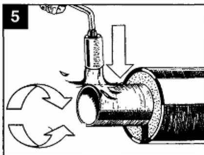
Pre calentamiento del tubo caloportador a 65°C como mínimo. Evitar el contacto entre la espuma y la llama.
