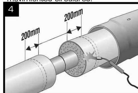
Mediante el soplete, pre-calentar la superficie a cubrir (anchura 200 mm a cada lado de la extremidad del PEHD) hasta un mínimo de 65°C. Controlar la temperatura en toda la superficie mediante el termómetro.
