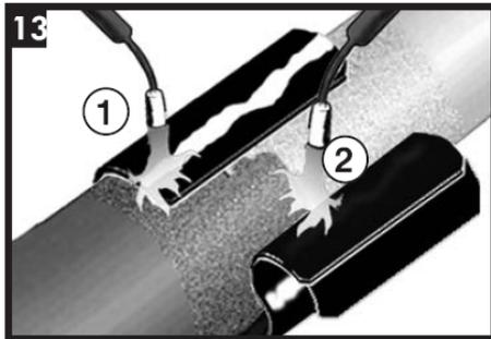
Enrollar el manguito alrededor del tubo dejando de 1 a 2 cm de juego y asegurarse del solape correcto. Calentar ligeramente el soporte de la parte superpuesta así como el adhesivo de la otra parte.
