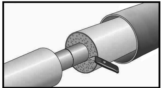
Limpiar con cuidado las extremidades de los tubos o de las piezas para eliminar cualquier huella de agua, de barro o de arena. Rascar la espuma de la cara divisoria (Cualquier huella de espuma húmeda debe ser eliminada de las extremidades).
