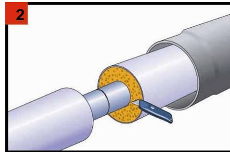
Limpiar con cuidado las extremidades de los tubos o de las piezas para eliminar cualquier huella de agua, de barro o de arena. Rascar la espuma de la cara divisoria (Cualquier huella de espuma húmeda debe ser eliminada de los extremos).
