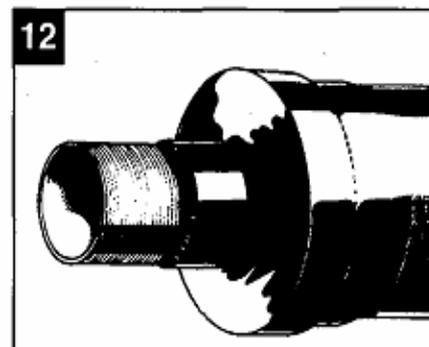
El forro debe adherir sobre la funda y el tubo caloportador sin burbujas de aire. No deben quedar huellas de quemaduras o partes salientes.
