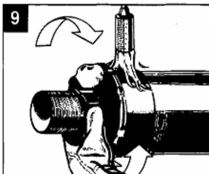
Comenzar la retracción del forro en la funda. Calentar con movimiento circular hasta que el forro recubra totalmente la funda. Dejar enfriar un momento antes de retraer el tramo y el extremo en el tubo caloportador.
