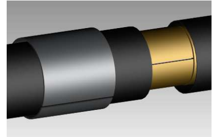
Colocación de coquillas de lana de roca
