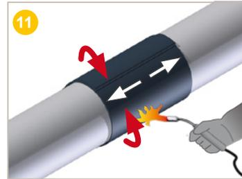
Continuer à **chauffer** en partant du centre vers chaque extrémité jusqu'au rétreint complet. Terminer par des mouvements horizontaux sur toute la surface de la bande. Le rétreint est complet lorsque l'adhésif dépasse de chaque côté de la bande.
