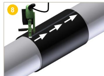
**Souder** la coupe longitudinale de la manchette avec un pistolet à extrusion PE.
