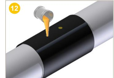
12) **Verser** le mélange dans l'un des trous d'injection de la manchette PEHD de diamètre 26 mm. Veiller à vider complètement le mélange en utilisant la spatule fournie à cet effet.
