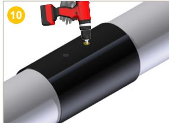
10) Une fois le test d'étanchéité à l'air réalisé et l'étanchéité de la jonction démontrée, **percer** le 2<sup>ème</sup> trou dans la manchette.
