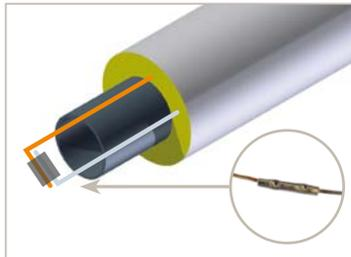
⚠ Pour l'opération 4, il est nécessaire de raccorder les fils à une extrémité.
