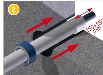
1) Positionner le passage de cloison étanche sur le tube.
